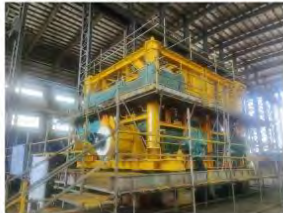
Production Manifold Module
